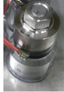
図 7・8 振動板への振動素子接着
