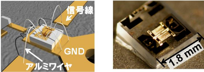
(a) ワイヤボンディングの模式図 (b) シャント型 MEMS スイッチ
