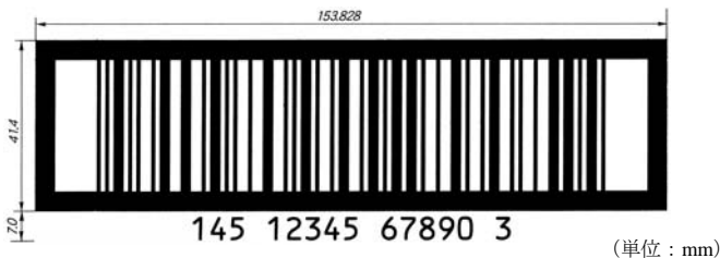
図 2・9 ITF シンボルの基本寸法 (JIS 規格 X0502) (印刷の都合上、実際の大きさと異なる)
