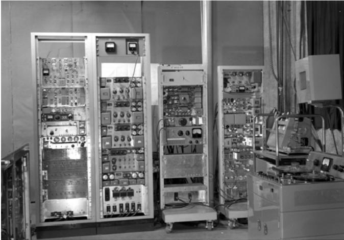
図3・8 ローマのコマ撮り電送送信装置
