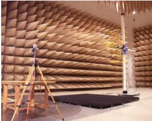
図 6・3 IEC 61000-4-3 放射イミュニティ試験例
