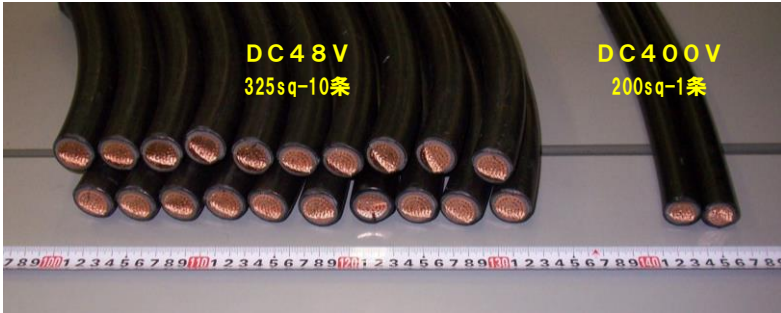
図 7・6 48 V 給電と 400 V 給電のケーブルの比
