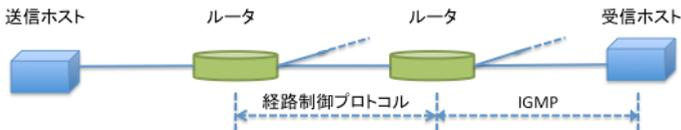
図 5・1 IP Multicast 概要
