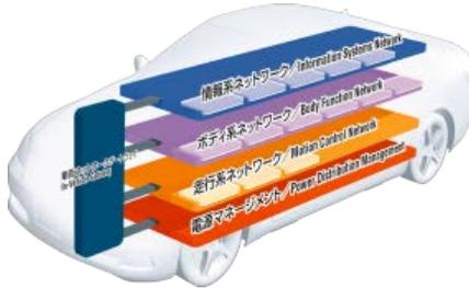
図 4・58 車載ネットワークの構成
