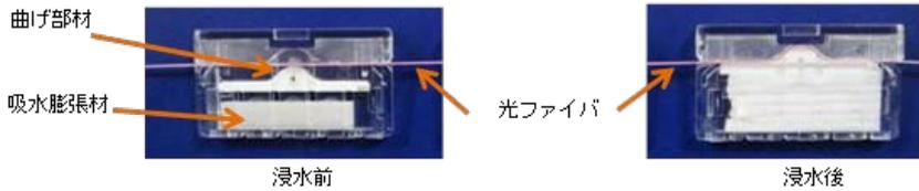
図 4・23 浸水検知モジュール
