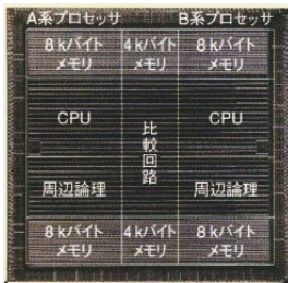
図 1-23 チップ内冗長化プロセッサ (FUJINE) 外観
