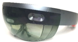
図 2・2 透過型ヘッドマウントディスプレイ
