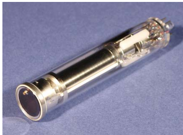
図 1・75 HARP 撮像管の外観
