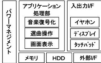
図 3・34 携帯型音楽プレーヤの一般的なハードウェア構成ブロック図
