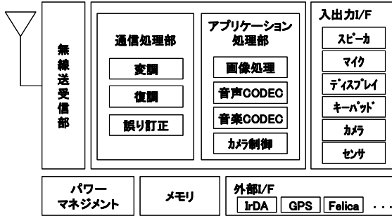
図 3-32 携帯電話の構成ブロック図
