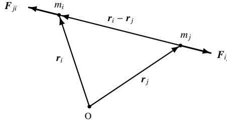
図 2・3 2つの質点を結ぶ直線に平行な内力 (図は反発力の場合)
