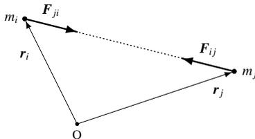
図 2・2 質点系の内力（図は引力の場合）
