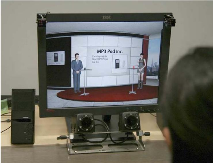
図 4・2 赤外線による視線追跡のステレオ装置をもつ気遣いプレゼンテーションエージェントのセットアップ<sup>33)</sup>
